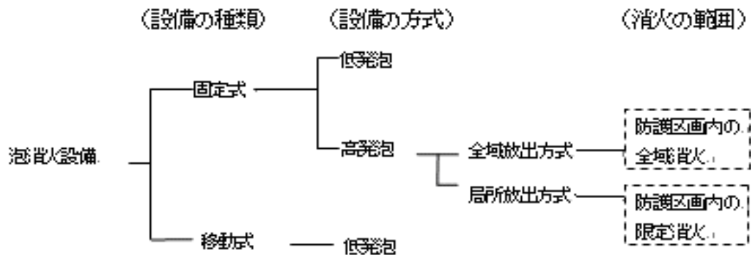
泡消火設備の種類と設備方式
