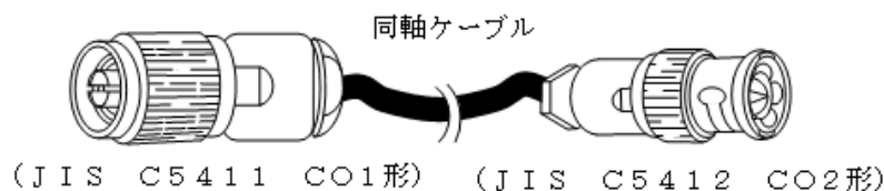
第23-2図 接続用の同軸ケーブル外観図
