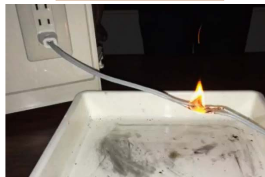
通電火災実験
